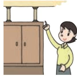
【タンス】 床側をストッパーなどで固定し、天井側はポール式器具で固定
