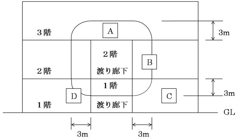
2 階の渡り廊下の接続部分からそれぞれ 3m 以内の距離にある部分の開口部を各階毎に判定する場合は、 $A+B+D=4\text{ m}^2$ 以下とすること。
