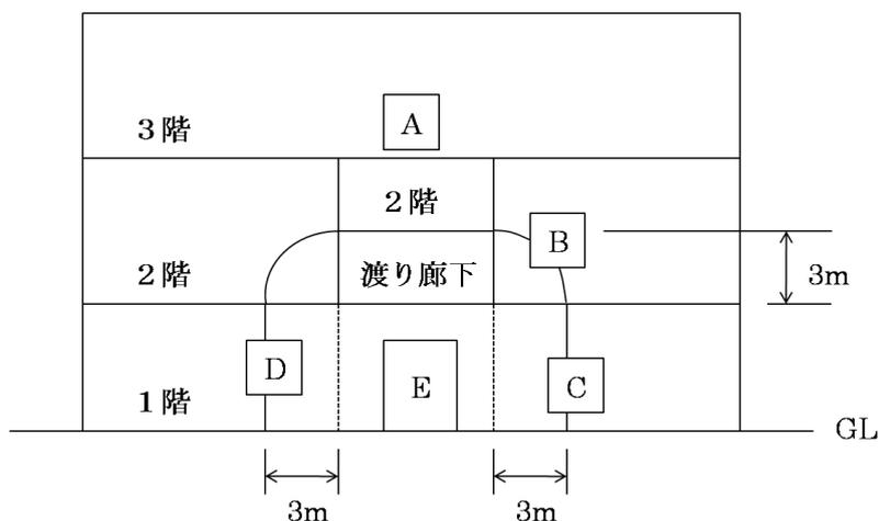
1階の渡り廊下の接続部分からそれぞれ3m以内の距離にある部分の開口部を各階毎に判定する場合は、 $B+C+D=4\text{ m}^2$ 以下とすること。
