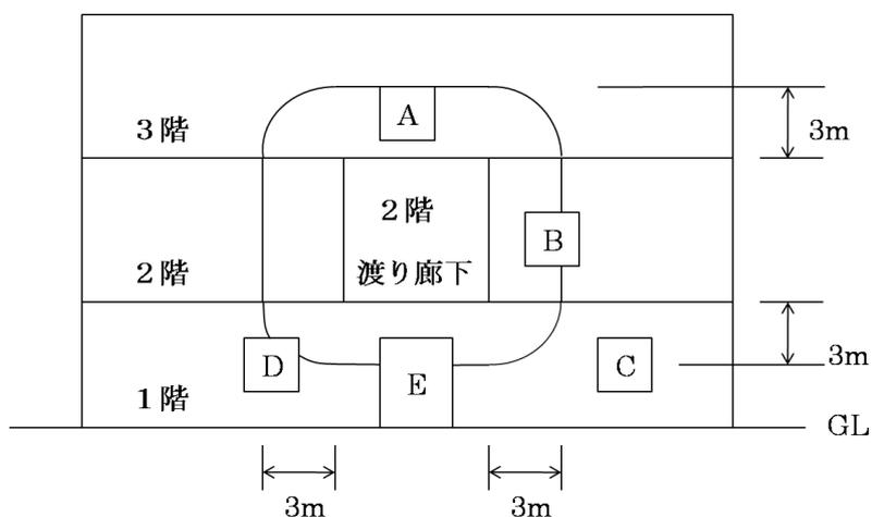
2階の渡り廊下の接続部分からそれぞれ3m以内の距離にある部分の開口部を各階毎に判定する場合は、 $A+B+D+E=4\text{ m}^2$ 以下とすること。
