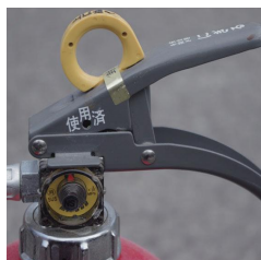
× 表示装置の脱落
