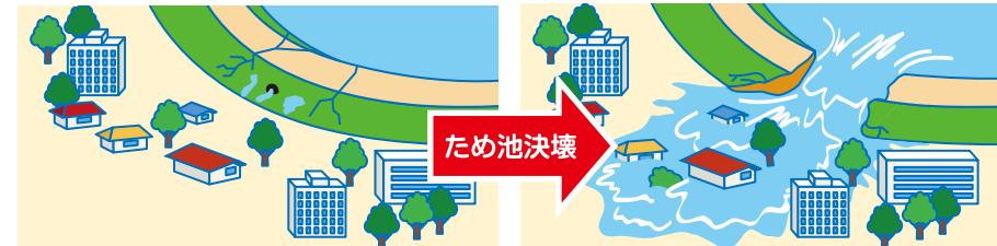
ほかにも堤防の沈下、斜面すべり、越流による破壊等が想定されます。
