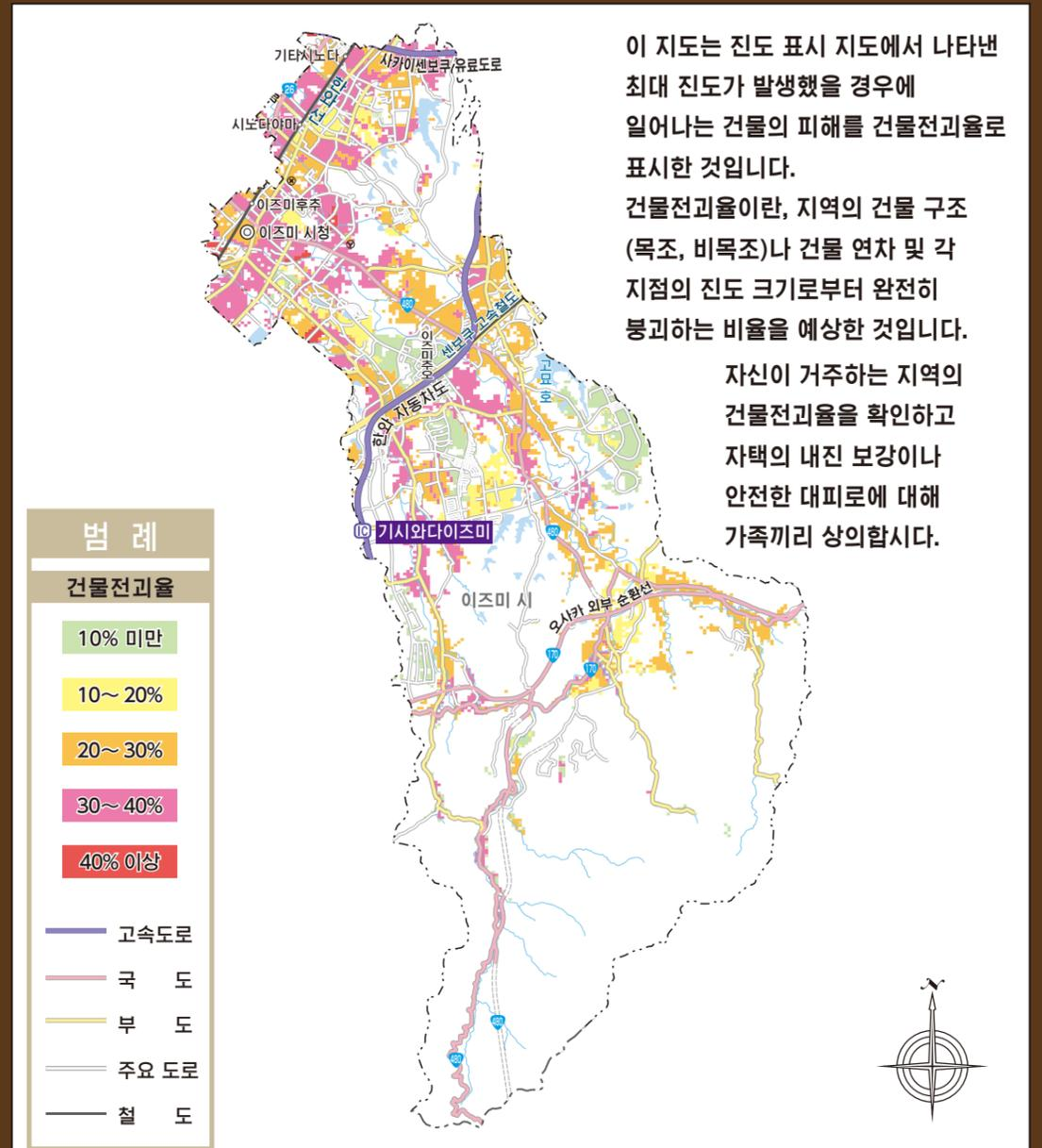
이 지도는 진도 표시 지도에서 나타낸 최대 진도가 발생했을 경우에 일어나는 건물의 피해를 건물전괴율로 표시한 것입니다. 건물전괴율이란, 지역의 건물 구조(목조, 비목조)나 건물 연차 및 각 지점의 진도 크기로부터 완전히 붕괴하는 비율을 예상한 것입니다.
