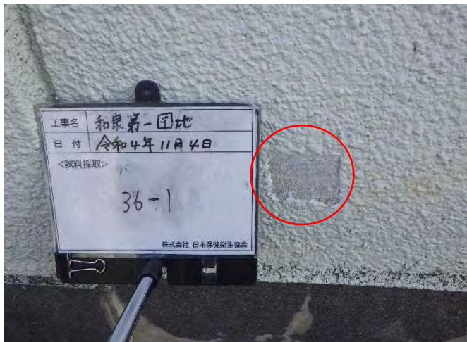
試料No.36 (採取後) 旭第一団地 23 棟 外壁 仕上塗材
