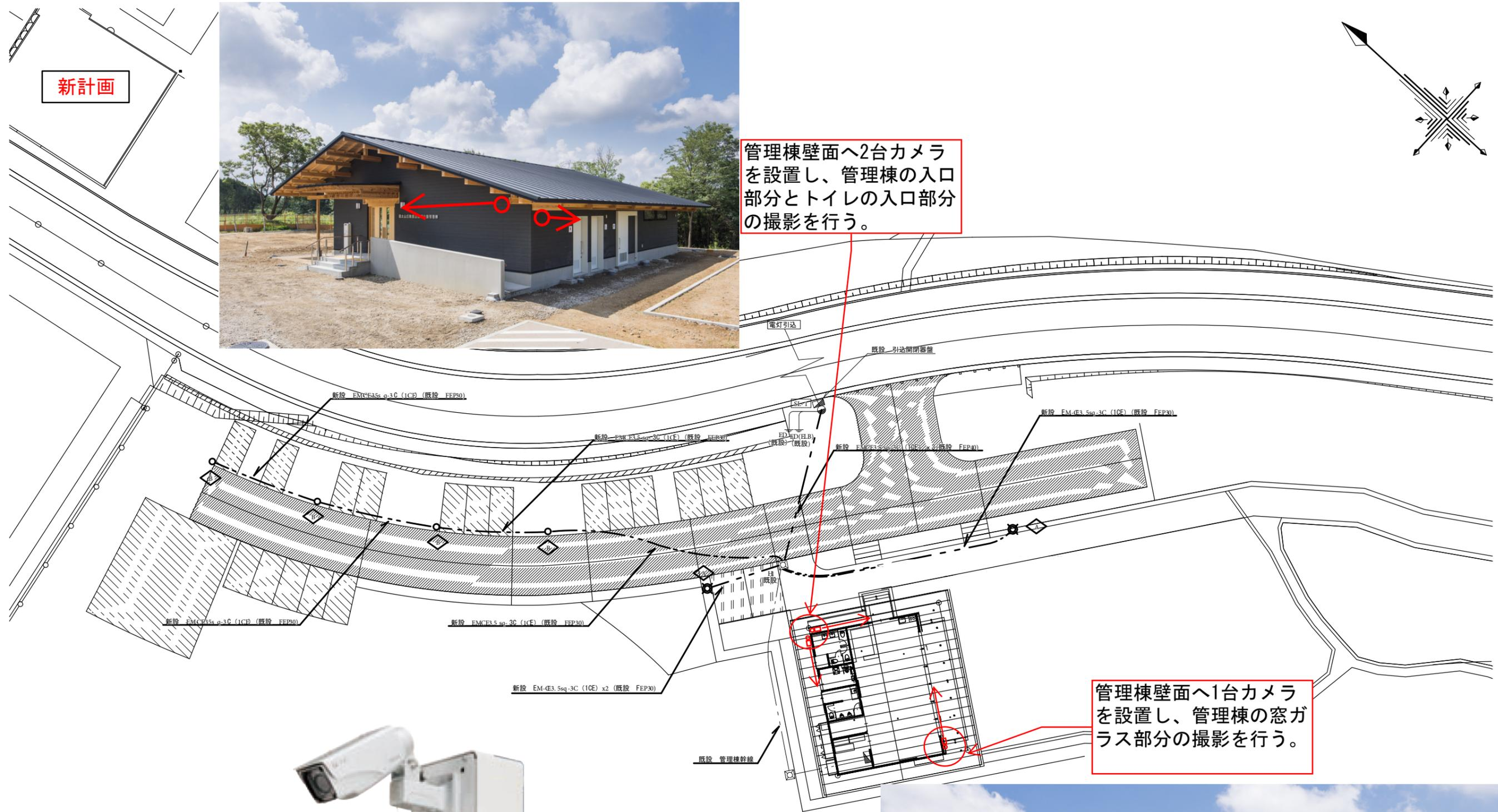
管理棟壁面へ1台カメラを設置し、管理棟の窓ガラス部分の撮影を行う。
