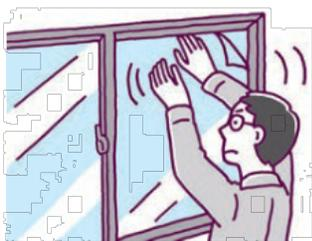
**2** 为了防止窗户玻璃破碎时碎片飞散，在玻璃上贴上防止飞散的薄膜。
