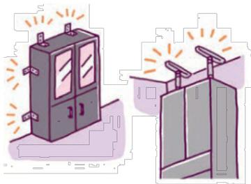
**1** 安装上防止颠倒的金属零件，防止家具等颠倒。
