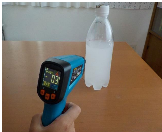
図 37 非接触式温度計で温度を測る様子
