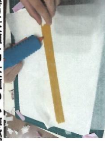
写真6:桁を接着する様子
