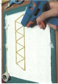
写真7:トラス橋の節点を接着する様子
