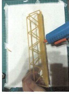
写真10:トラス橋の接着の様子
