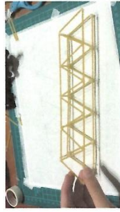
写真8:トラス橋の左右両側、接着後
