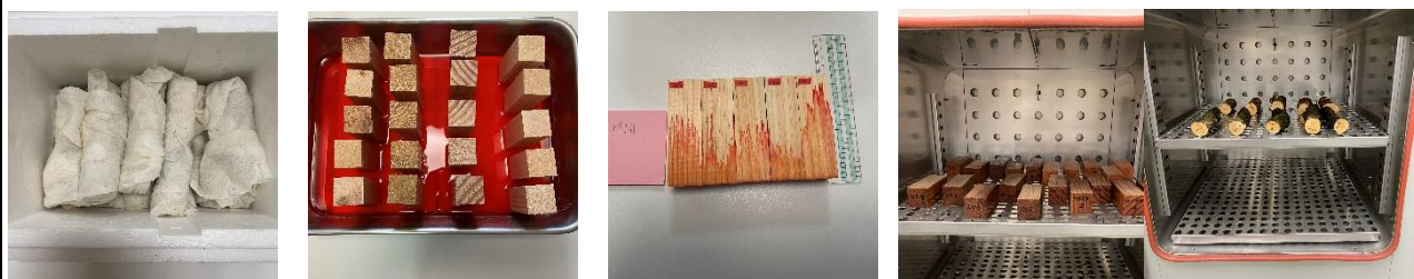
(a)届いたみかんの木 (b)吸水の状況 (c)吸水状況の確認 (d)乾燥機に入れて乾燥させる
