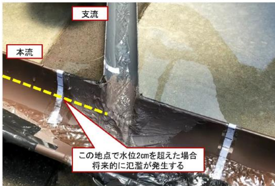
図1 本流水位の基準位置と支流の関係
