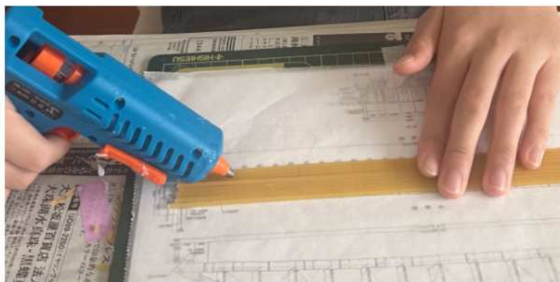
写真2:桁を接着する様子
