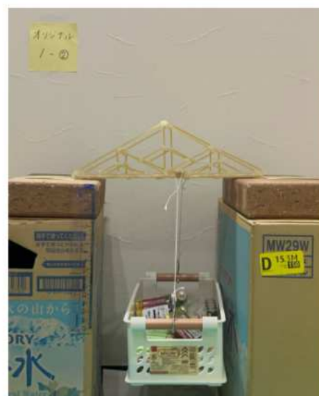
写真7:橋に吊るした容器におもりをのせて計測した状態
