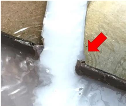
図-12 支流幅狭 右岸側からの氾濫
