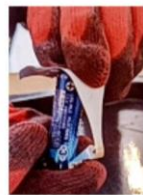
図13 2mmの銀紙に電池を繋いだ瞬間 図14 2mmの銀紙に電池を繋いだ直後 図15 3mmの銀紙に電池を繋いだ直後 図16 3mmの銀紙に電池を繋いで5秒
