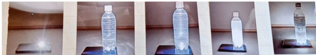
図8 携帯ライトのみ明度 図9 水のみ明度 図10 水と牛乳(一滴)の明度 図11 水と牛乳(5滴)の明度 図12 牛乳のみ明度
