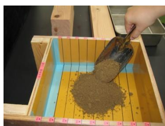
写真8 型枠に土を入れる
